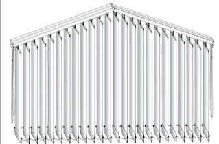
mit federgespannten Lamellen zwischen 2 Schienen (auch für Dachschrägen geeignet)
