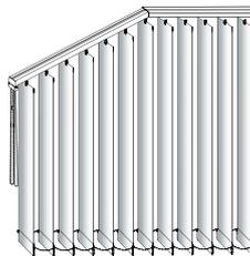
Slope-Anlage und gerade Anlage mit Überlappung
