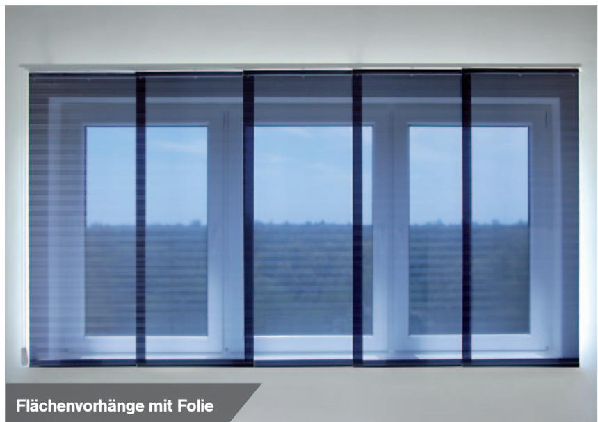
sind transluzent, d.h. sie lassen natürliches Licht passieren, reflektieren einen Großteil an Wärmestrahlung und gewährend stets freie Sicht nach außen.
