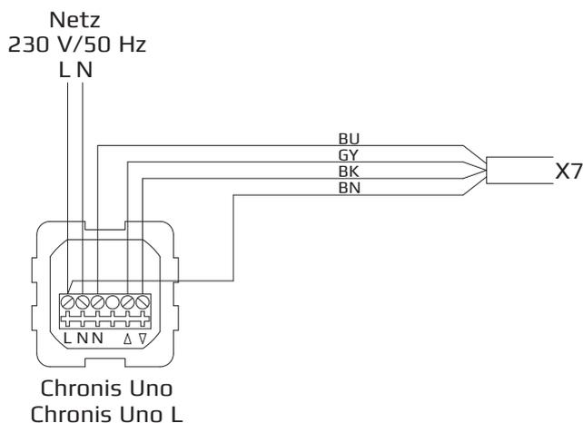
Steuerstrom je Antrieb/Funktion: 5 mA
