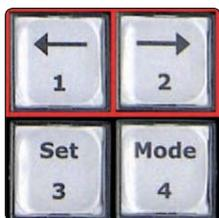
Mit den Tasten -> und <- kann der Verfahrmotor bedient werden
