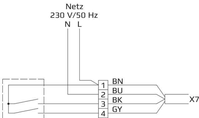
Steuerstrom je Antrieb/Funktion: 5 mA
