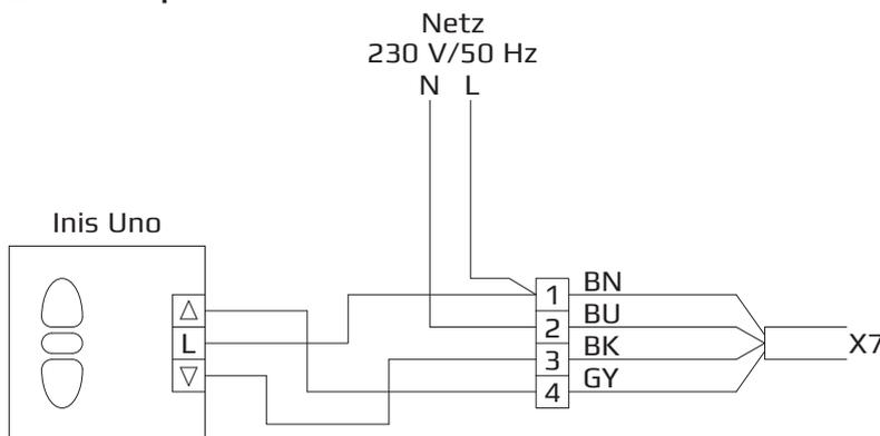
Steuerstrom je Antrieb/Funktion: 5 mA
