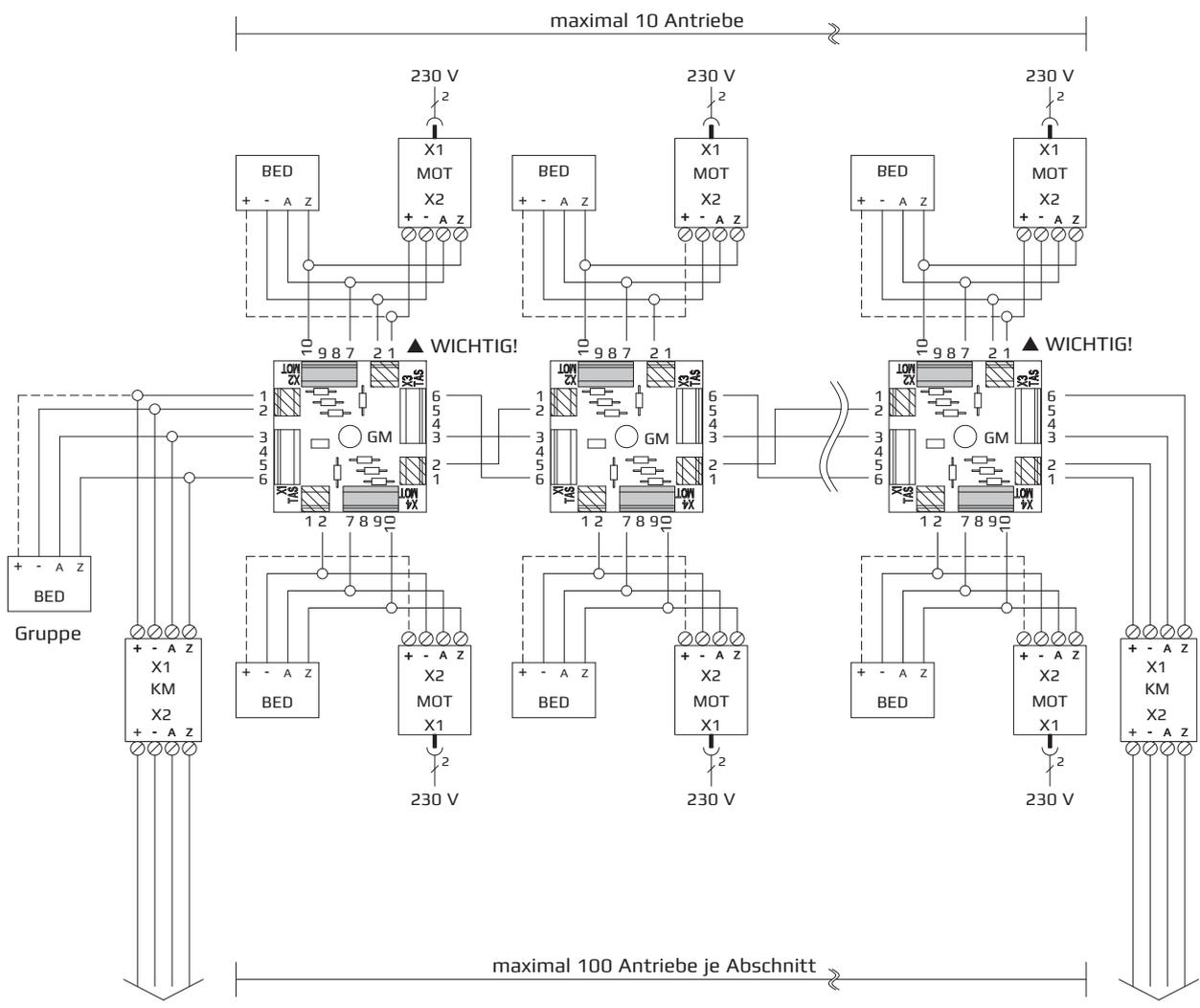
▲ WICHTIG! Nur 1 Motor darf die Bedienung der Gruppe und/oder ein Koppelmodul mit Spannung versorgen
