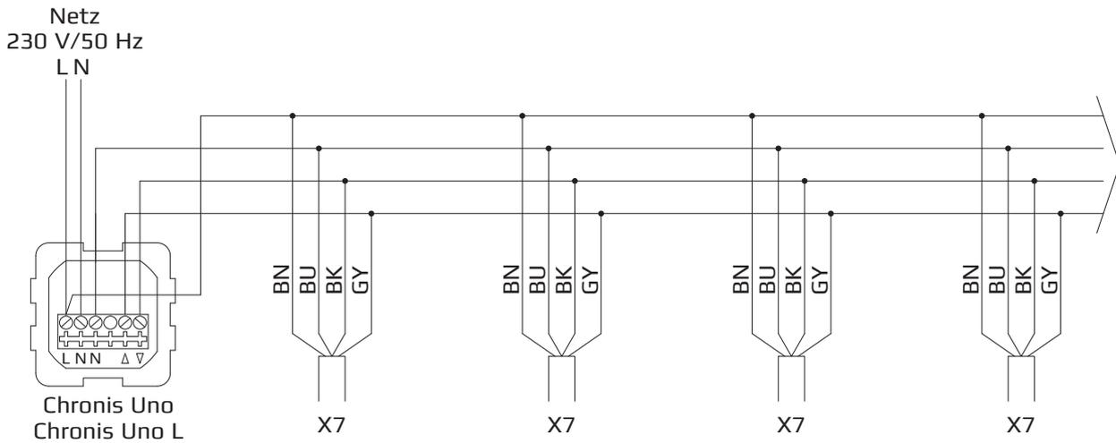
Steuerstrom je Antrieb/Funktion: 5 mA
