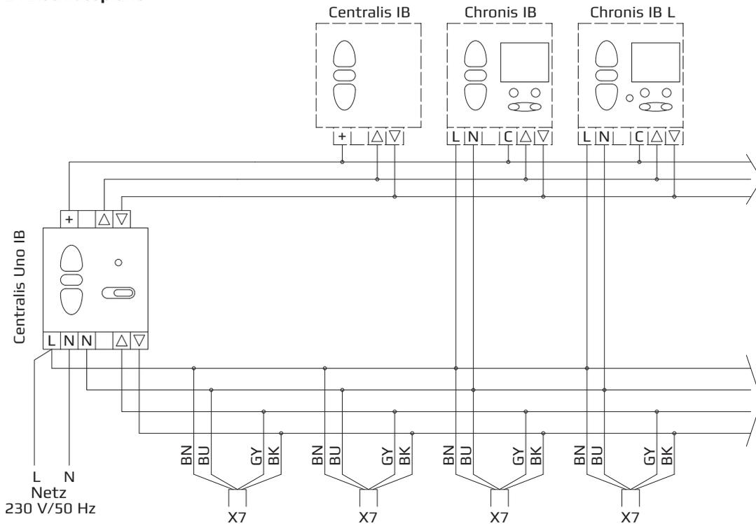
Steuerstrom je Antrieb/Funktion: 5 mA
