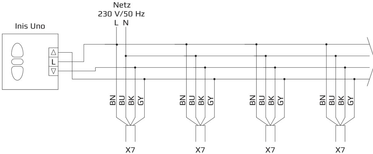
Steuerstrom je Antrieb/Funktion: 5 mA
