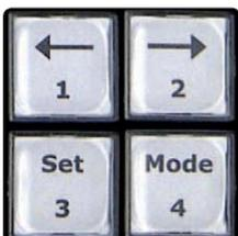
Mit einem kurzem Druck auf eine der Tasten kann die jeweilige Option (1, 2, 3, 4) ein- oder ausgeschaltet werden.
