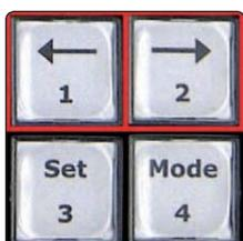
Mit den Tasten -> und <- kann der Wendemotor bedient werden
