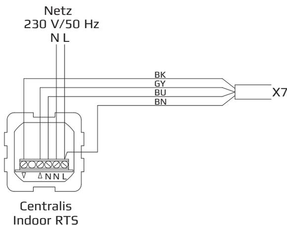
Steuerstrom je Antrieb/Funktion: 5 mA
