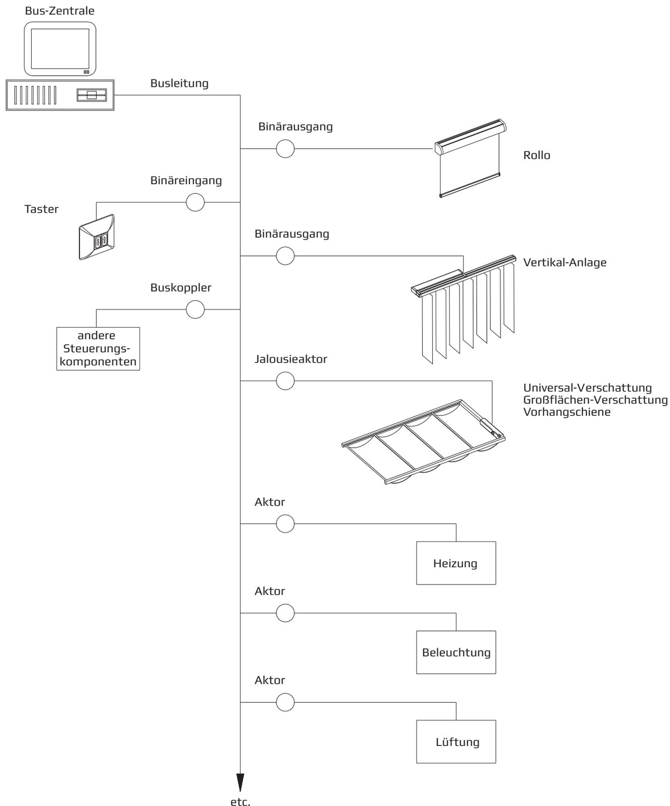
Hier ist als Übersicht dargestellt, welche Variationsmöglichkeiten sich mit unserem Motorsystem ergeben. Die Kombination zwischen Rollos und Vertikal-Anlagen ist in dieser Abbildung gut zu erkennen. Mit der Vielzahl der Steuerungsmöglichkeiten sowie Einzel-, Gruppen- oder Zentralsteuerung lassen sich alle individuellen Schaltungsvarianten erstellen.
