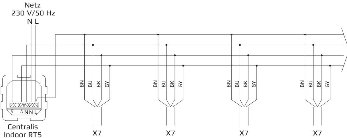
Steuerstrom je Antrieb/Funktion: 5 mA
